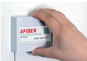
**Wichtig:** Beim Aufsetzen der OTO-Box bitte darauf achten, dass das Glasfaserkabel nicht geknickt wird! Drücken Sie die OTO-Box vorsichtig und gerade auf die Montageplatte, bis sie einrastet.
